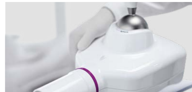
RXDC - tecnologia HyperSphere Integrato al riunito, radiografico e palmare non richiedono altri punti d'installazione. Ottimo parallelismo grazie alla collimazione di 30 cm associato al fuoco da 0,4 mm, garantisce immagini eccellenti. Toccando le zone touch-sensitive, la testata si sblocca e ruota liberamente attorno al giunto sferico.
