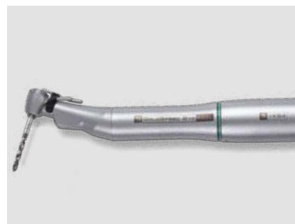
Contrangolo EVO R20L Specifico per chirurgia con rapporto 20:1, il contrangolo EVO R20L è autoclavabile e termodisinfettabile. Dispone di un sistema di raffreddamento interno e spray esterno, nonché illuminazione LED con generatore integrato.
