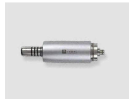
Micromotore i-XS4 Il micromotore brushless è integrato all'elettronica del riunito che gestisce anche la pompa peristaltica. Il software permette un controllo preciso e sicuro della velocità e dei valori di coppia che raggiungono 70 Ncm con contrangolo EVO R20L.
