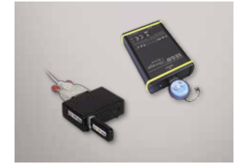
Documentazione del processo mediante chiavetta USB I dati contenuti nella chiavetta USB vengono trasferiti automaticamente, ad es. con il software di documentazione SegoSof o DIOS, al computer dello studio. Il processo viene approvato, firmato in modo digitale e archiviato.
