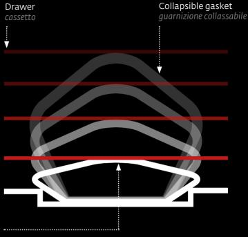
High surface area contact when closed massimo contatto con la superficie quando chiuso
